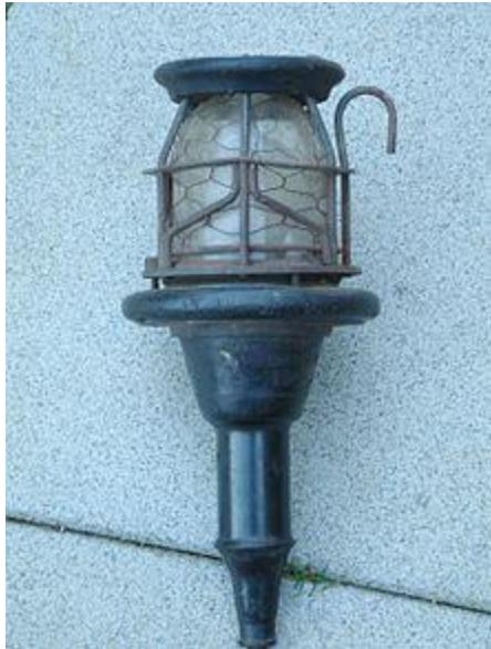
Esta lámpara de inspección está construida de modo que no pueda descomponer una explosión cuando está rodeada de gases o polvos inflamables específicos.
